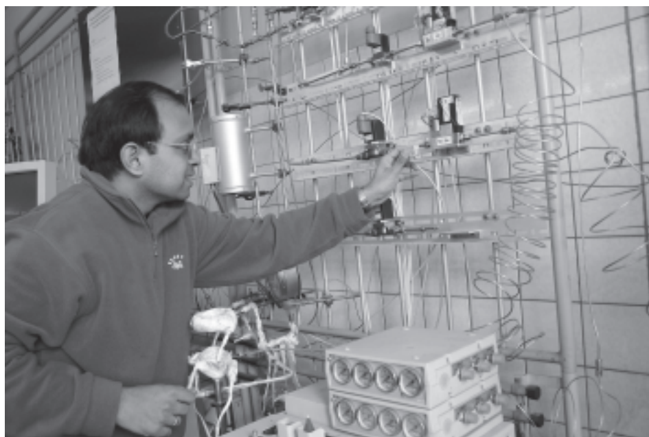
Humboldtstipendiat Dr. Salil Varma aus Bombay an der Anlage zur Entstickung von Abgasen im Institut für Technische Chemie. Foto: Dr. Bärbel Adams
